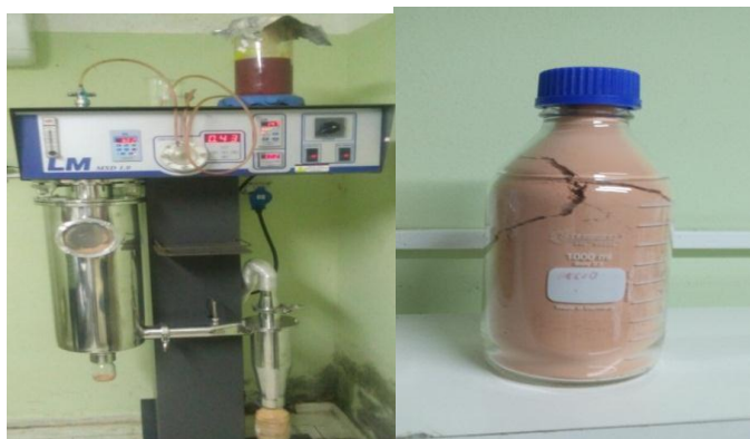
Figura 3 - Obtenção do microencapsulado de própolis vermelha por spray dryer.
