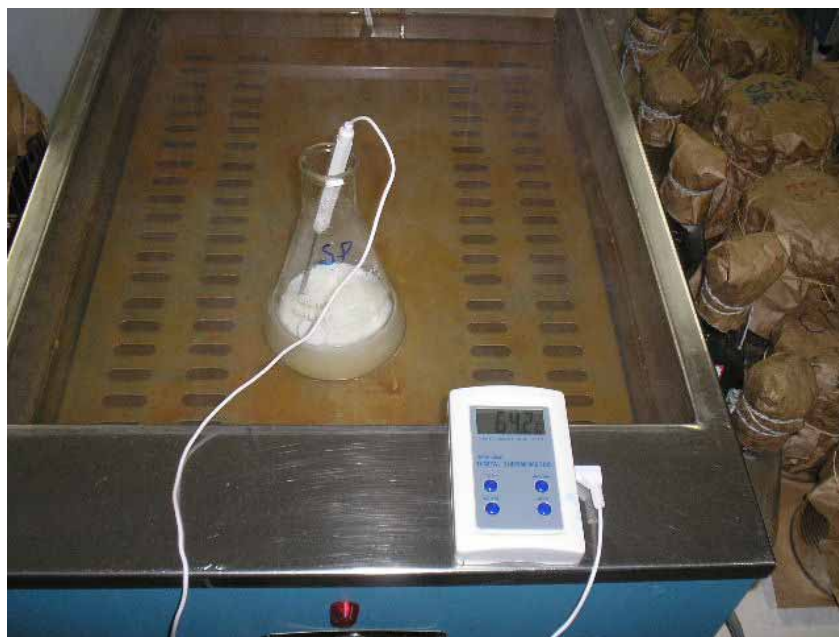
Figura 5: Processo de pasteurização lenta do soro de leite
