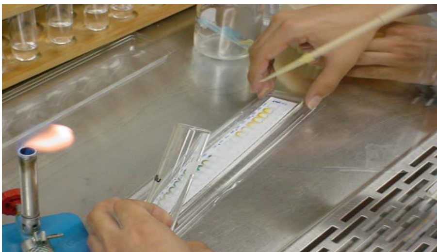
FIGURA 22 – Inoculação da suspensão de microrganismos nas galerias do sistema API para sua identificação através das respostas bioquímicas.
